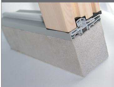
Die DRGpor HW 140 Konstruktionsplatte besteht aus einem hochverdichteten, expandierten, formgeschäumten, hydrophobierten Polystyrol-Hartschaum. Diese Konstruktionsplatte wird für eine hochwertige Unterkonstruktion Ihrer Fenster und Türen verwendet. Durch die hervorragenden Dämmeigenschaften schließt sie sämtliche Wärmebrücken aus.
